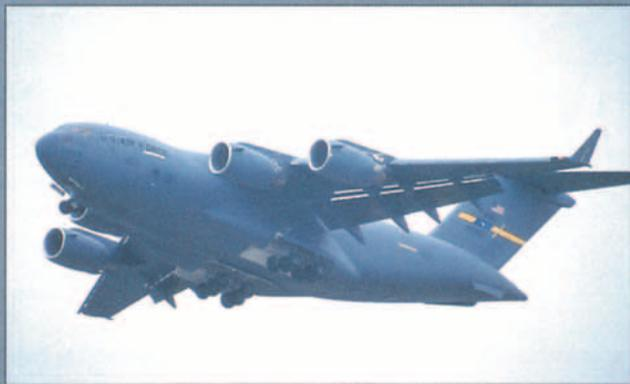
*Pasada en vuelo lento del C-17 Globemaster III con sus amplias superficies de biper sustentación extendidas.*
