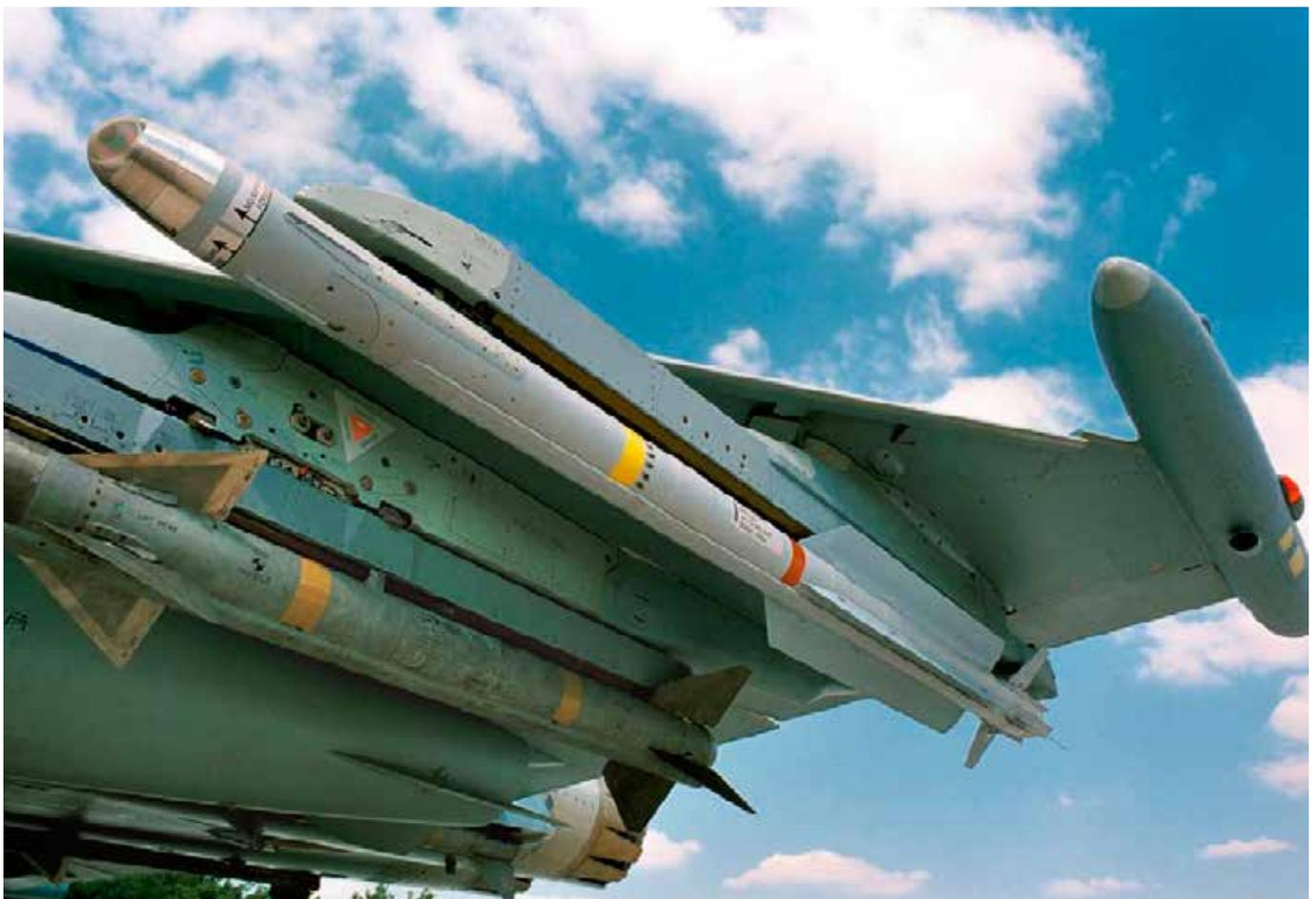
Fig. 3. Arriba: sección de guiado del Iris-T. Buscador de IIR de 128 x 128 elementos con  $\pm 90^\circ$  de FOR (Field of Regard) en los ejes de cabeceo y balance. Abajo: Iris-T en la estación subalar externa del EF2000. Se destacan las bandas amarilla y marrón que indican, respectivamente, la presencia de explosivos y motores cohetes. (Fuentes: <http://www.defensa.gob.es> [texto] y <http://www.diehl-bgt-defence.de> [imagen]).
