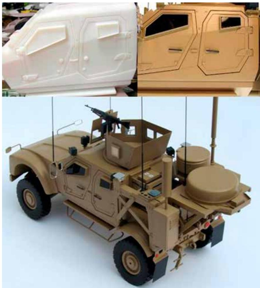
Fig. 4. La impresión 3D haría posible la fabricación de repuestos de plataformas para llevar a cabo reparaciones de un modo rápido y económico. (Fuente: [www.kiwimill.com](http://www.kiwimill.com)).
