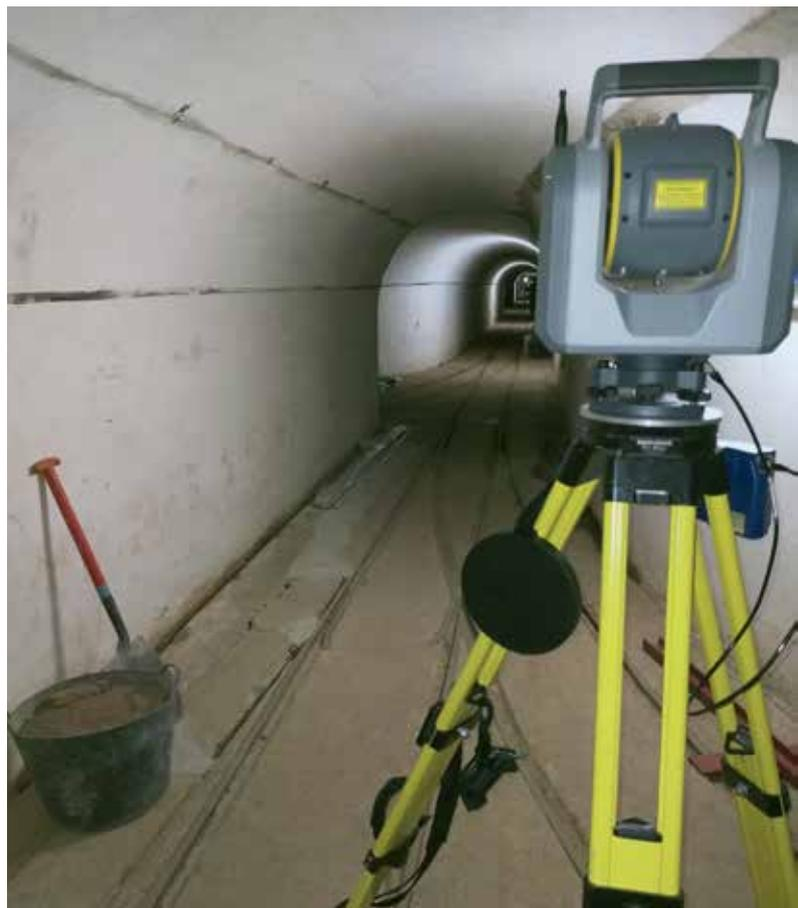
a cabo la captura masiva de datos a través de una estación total láser-escáner SX-10, es decir, un aparato óptico-electrónico que mide ángulos y distancias al objeto que apunta el operador mediante un antejo. En el caso de la SX-10, el apa-
