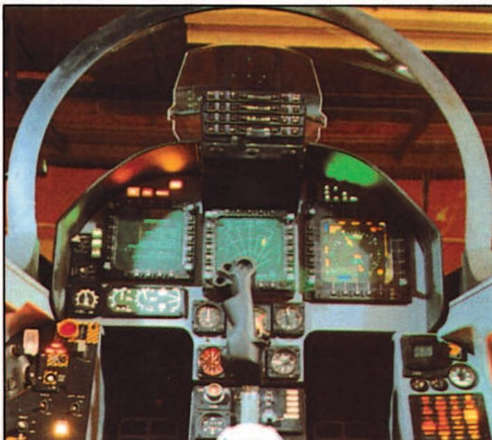
La avanzada cabina del Lavi, donde destaca la posición central de la palanca de mando, y las tres pantallas multifunción.
