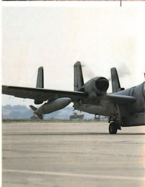
*OV-10 Mohawk del Batallón 1 de U.S. Army. La barquilla bajo el fuselaje corresponde a la antena del radar de visión lateral APS-94.*
