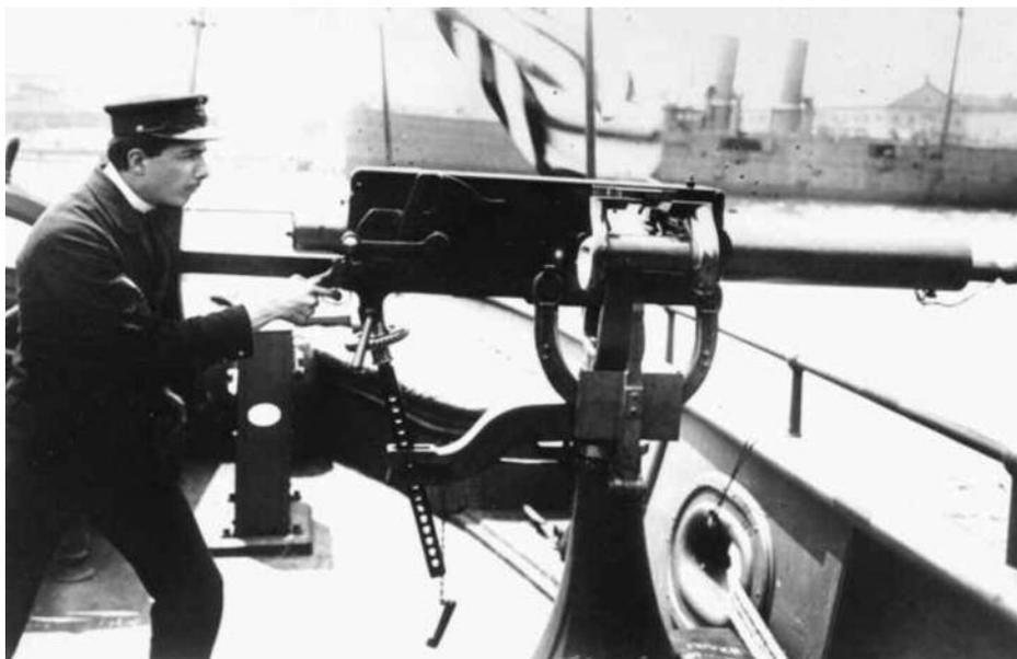
Una ametralladora Maxim de 37 mm, *Pompom*, en un buque de la US Navy. En el lateral puede observarse el cilindro sobre el que deslizaba la cinta de lona. (Foto: Archivo MDR Almirante de Castilla)
