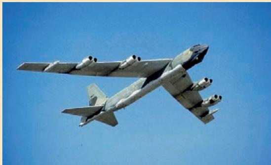
Lámina 8. Boeing B-52 ( USAF). El 15 diciembre 2006, voló con una mezcla de Syntroleum y JP-8 (50/50) en todos los ocho motores durante 7 horas. La USAF le concedió el certificado de aeronavegabilidad el 8 de agosto de 2007.
