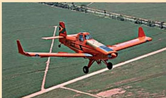
Lámina 6. Avión agrícola brasileño EMB-202- "Ipanema" que desde 2004 tiene certificado de aeronavegabilidad para usar solo bioetanol.
