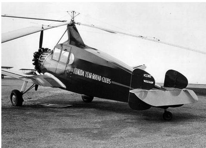
**Figura 3.** El modelo PA-19 era el autogiro más grande construido, la adaptación sanitaria era sencilla al poderse realizar una puerta para camillas en este lateral del fuselaje. Imagen colección Bruce H. Charnov
