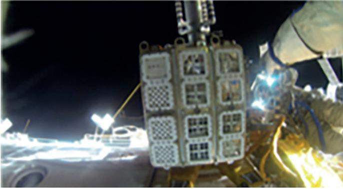
**Figura 2.** Plataforma EXPOSE-R2 con las muestras de vuelo de *Circinaria gyrosa* en la Estación Espacial Internacional (cortesía de la ESA)
