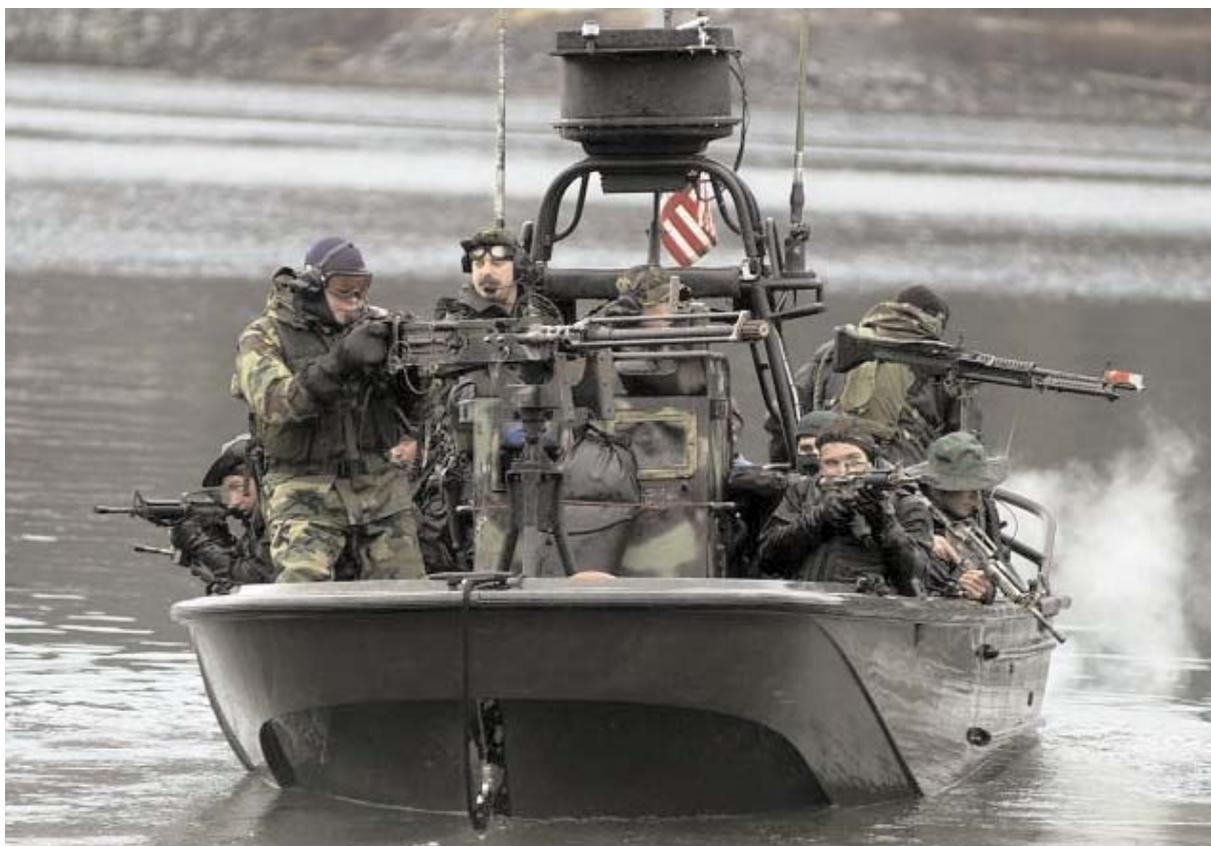
Embarcación de los SEAL, en la que se puede observar una 12,7 montada a proa y una M-60 a popa-babor.
