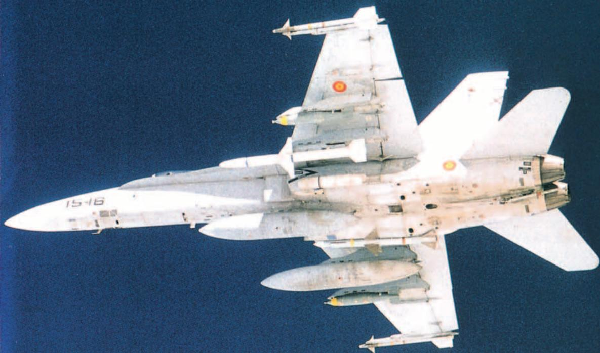
*C-15 con Sidewinder AIM-9LI, BRT 250, AGM-88, FLIR y AIM-7F.*
