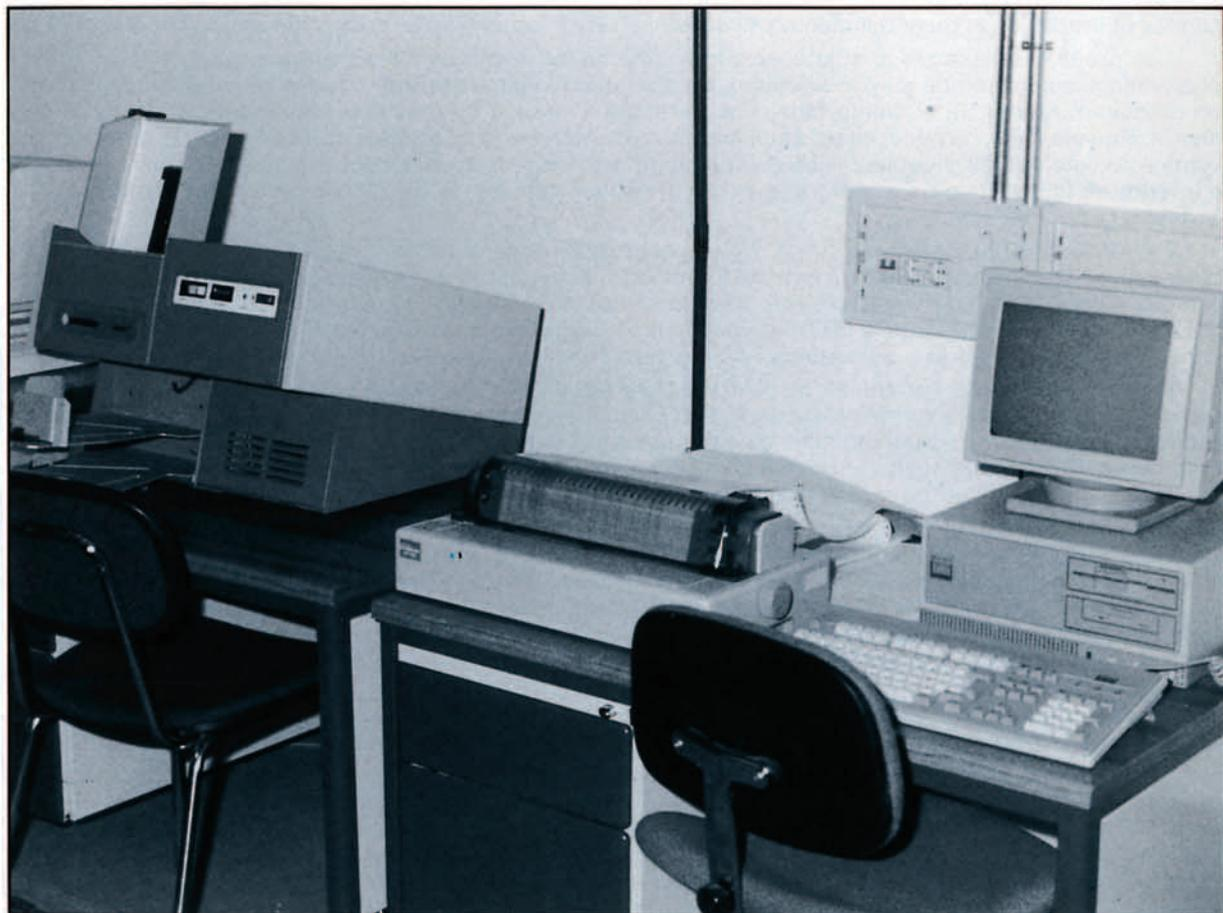
*Equipo de corrección mecanizada de pruebas, compuesto por: Lectora, DATASCAN Serie 7 y Ordenador Olivetti M-240.*
