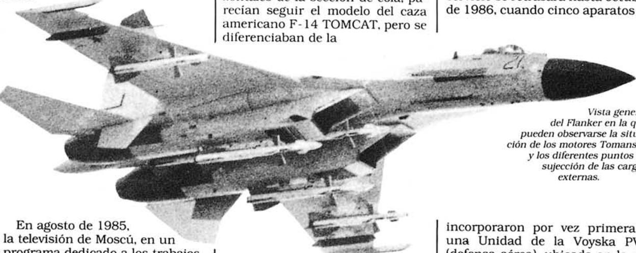
*Vista general del Flanker en la que pueden observarse la situación de los motores Tomansky y los diferentes puntos de sujeción de las cargas externas.*
