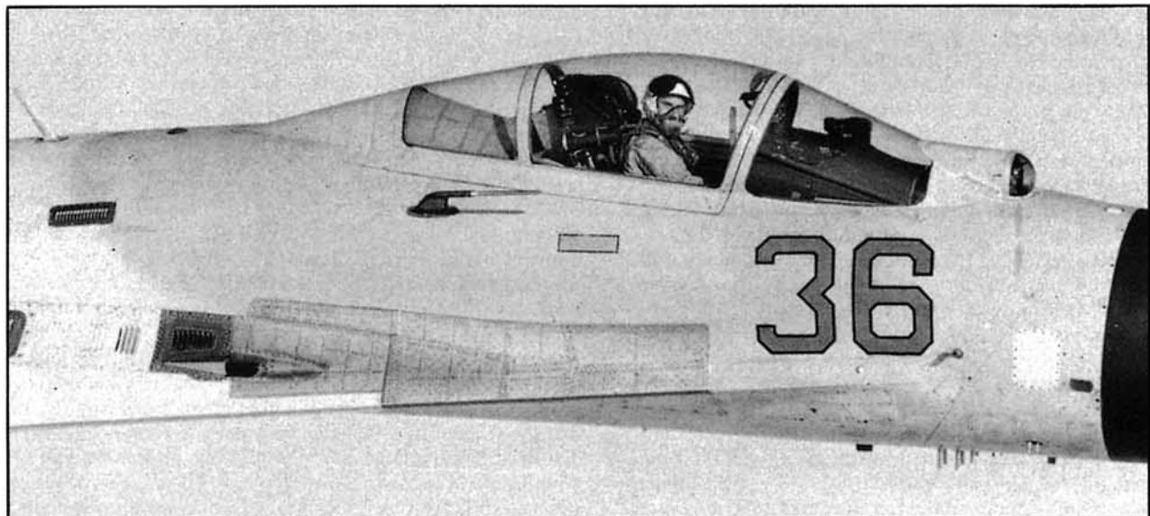
En este primer plano del FLANKER, tomado por un tripulante del P.3-B noruego, pueden distinguirse detalles muy concretos del avión. Delante de la cabina está el sensor de búsqueda y seguimiento de infrarrojos IRSTS. El piloto carece de visor en el casco, la visibilidad de la cabina es excelente y se puede observar el presentador "Head-up". Ya en el borde de ataque derecho, se encuentra el gran orificio del cañón y la zona reforzada, junto al fuselaje, para reducir los efectos de los gases.
