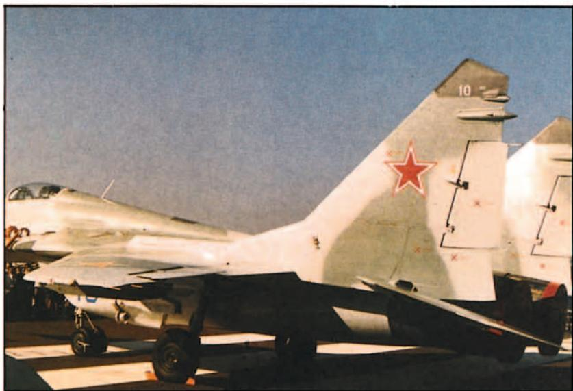
Detalle de las colas del MIG 29 con las antenas del sistema alertador de radar Sirena III.
