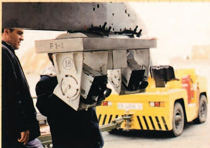
*Pod de cámaras bajo ala para filmar la separación de las cargas lanzadas*
