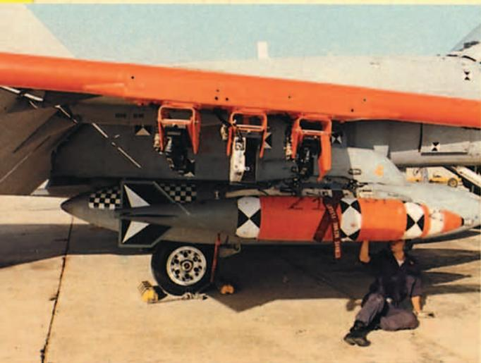
*Avión C.15 preparado para realizar vuelo de ensayos de lanzamiento de bombas BR-500*
