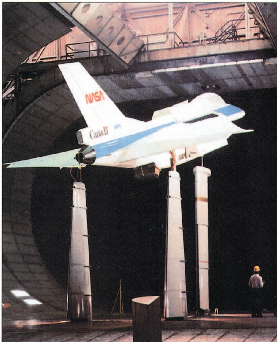
El E-7A montado en el túnel aerodinámico de baja velocidad de 40 x 80 pies del Ames Research Center de la NASA.
