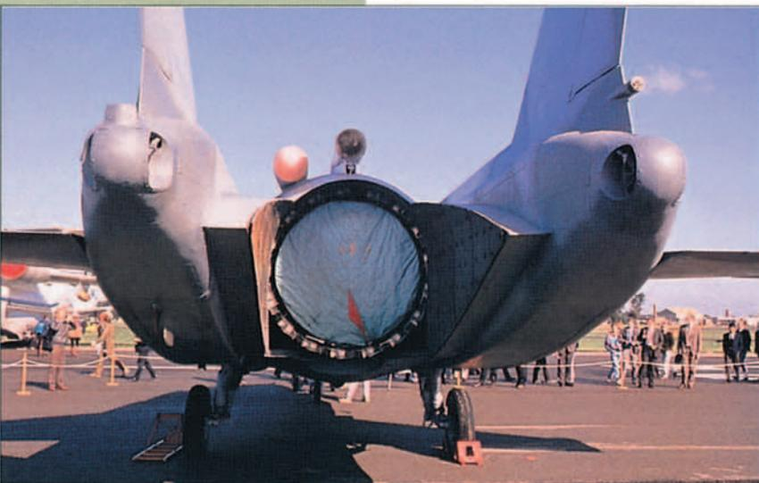
*La tobera del motor principal R79 y las dos pequeñas toberas circulares situadas detrás de los estabilizadores verticales para control en guiñada del Yak-141. Otras toberas en los extremos del ala y en la proa completan su sistema de control para vuelo vertical.*
