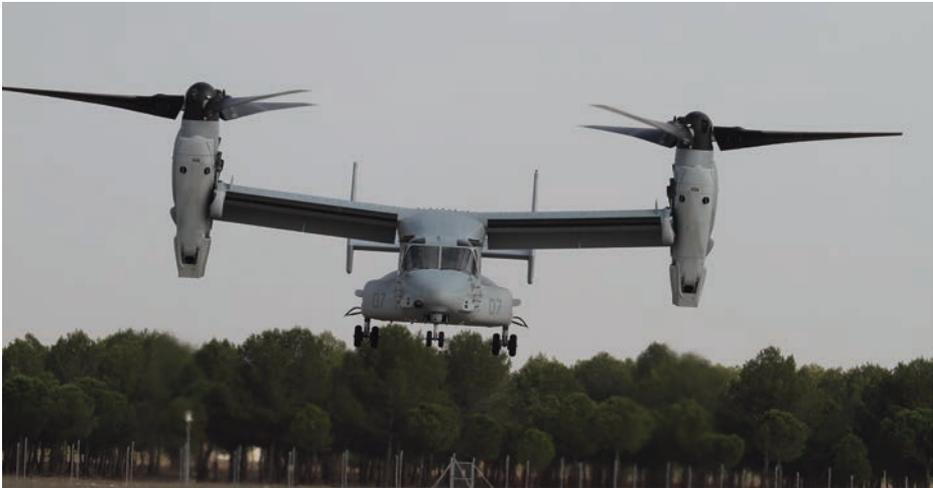
Vista frontal de un *MV-22B* aterrizando configurado como un helicóptero.
