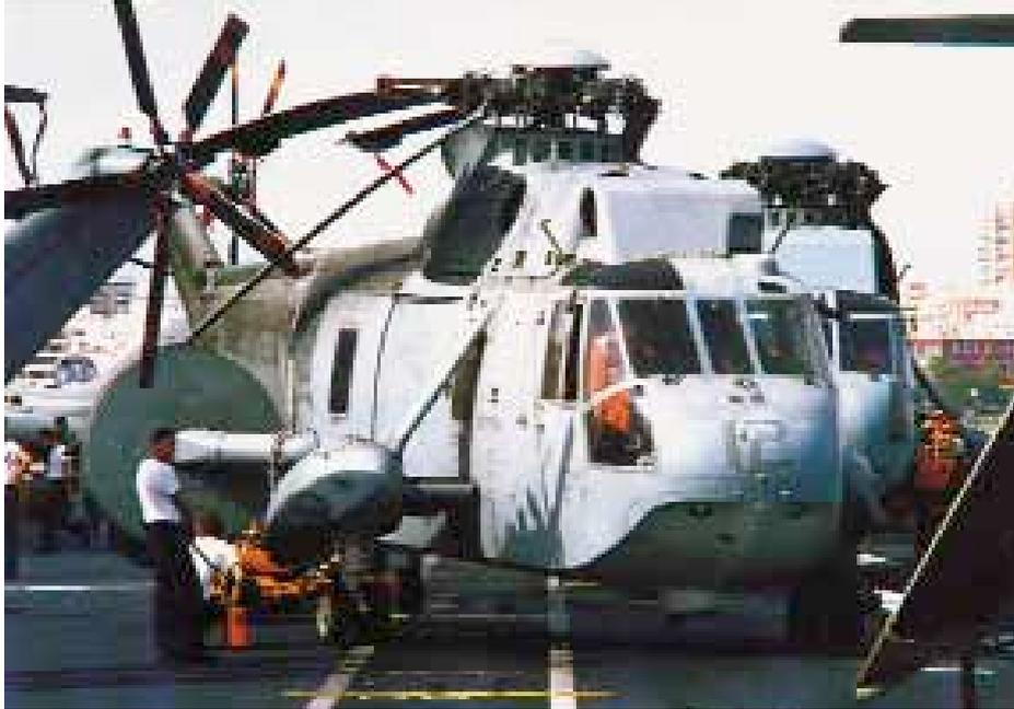
Helicópteros de la 5.<sup>a</sup> Escuadrilla con radar Searchwater en la cubierta de vuelo del *Príncipe de Asturias*. (Foto: L. Díaz-Bedia).
