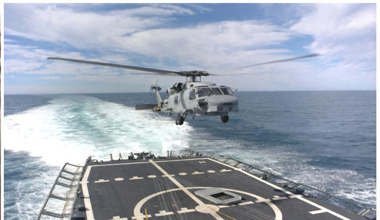
Fig. 3. Helicóptero aterrizando empleando sistema RAST. (Ref. <http://www.ausairpower.net/Seahawk-RAST-2.jpg>)
