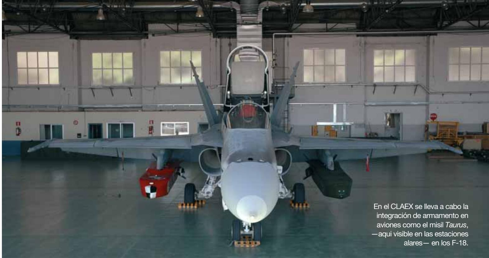
En el CLAEX se lleva a cabo la integración de armamento en aviones como el misil *Taurus*, —aquí visible en las estaciones alares— en los F-18.
